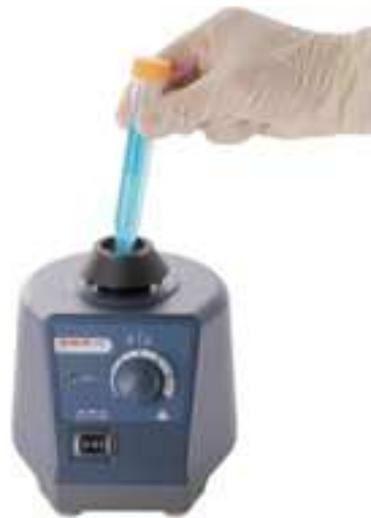
L'agitateur Vortex largement utilisé dans les sciences de la vie, les sciences physiques et les champs d'analyse chimiques, convient aux re-suspensions de cellules ou de produits chimiques en granulés dans des tubes jusqu'à 15 ml.
